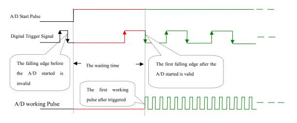
Figure 5.2 Falling edge Trigger
